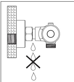
**25 bar:** Testtryk / Testtryck / Testtrykk / Test pressure / Testipaine
